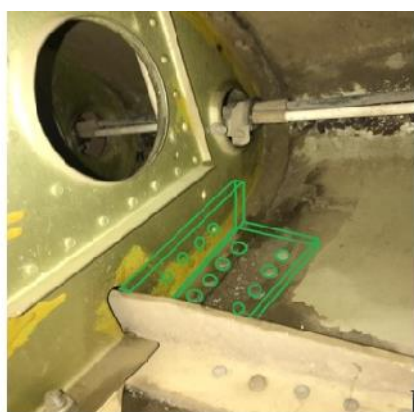
استفاده از دو تیر L شکل در طرفین ریب در ناحیه آسیب.
